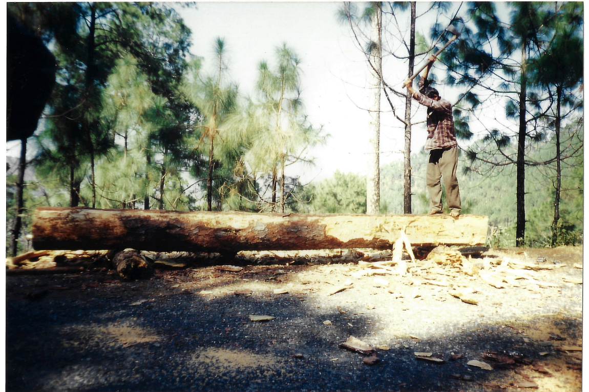
12 Ausgehend von den Kerben wird das Holz grob abgeschwartet
