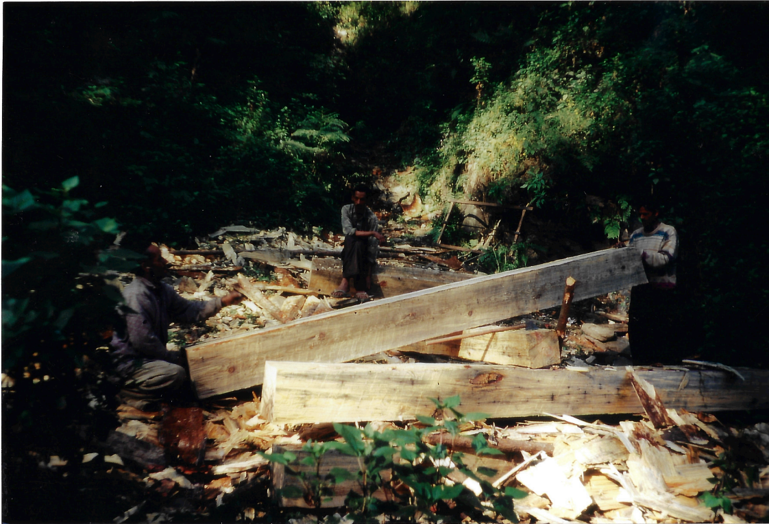
Kumaon: 19 Der Holzblock wird beidseitig mit Schnurschlägen markiert
