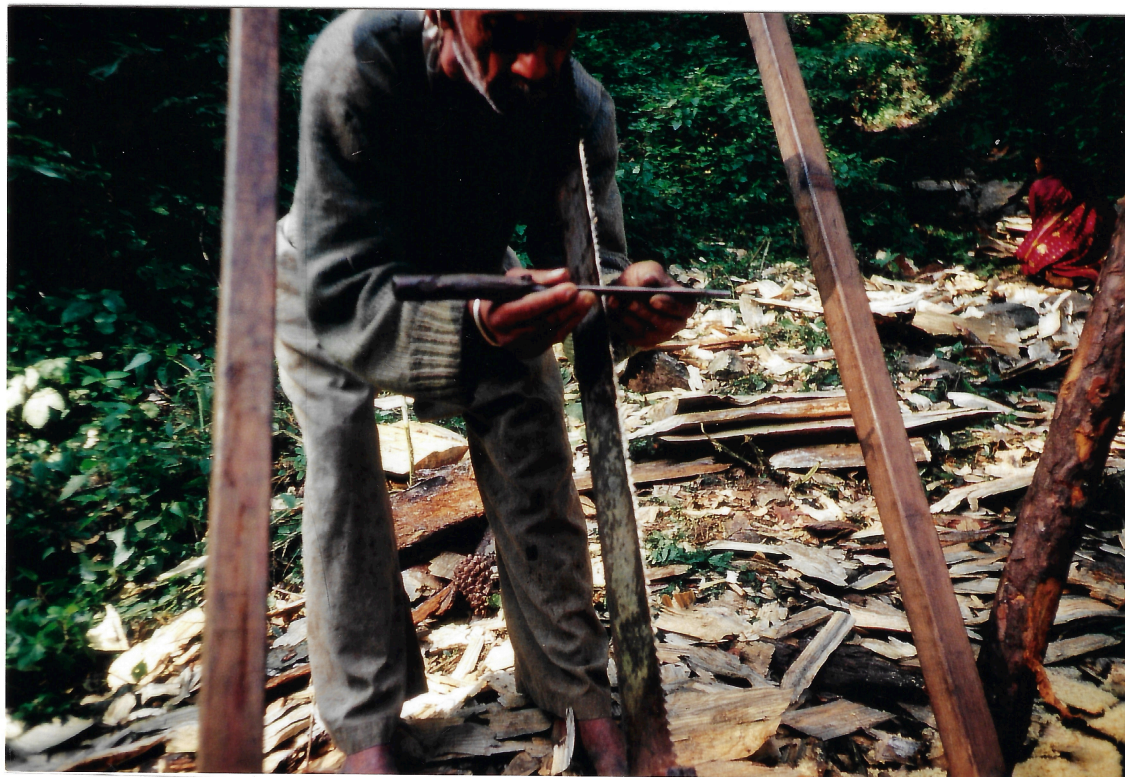
18 Die Sägezähne werden nach Bedarf mit der Feile geschränkt
