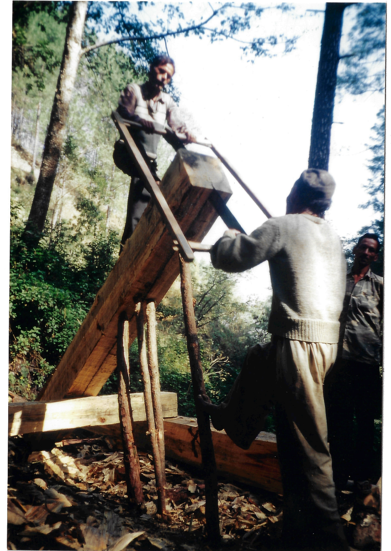
20 Der Anfang des Sägeschnitts erfordert höchste Präzision, da davon der gesamte Arbeitsvorgang abhängt
